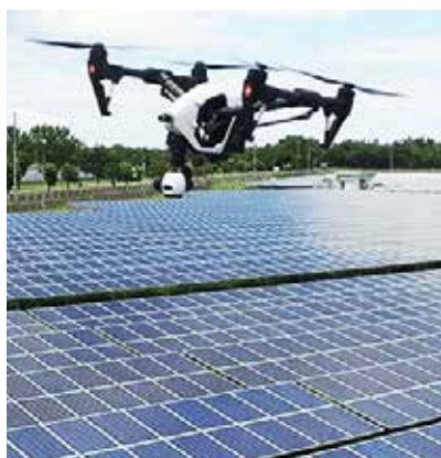
Hình 34: Phát hiện lỗi ở tấm quang điện sử dụng thiết bị bay có camera và cảm biến nhiệt
