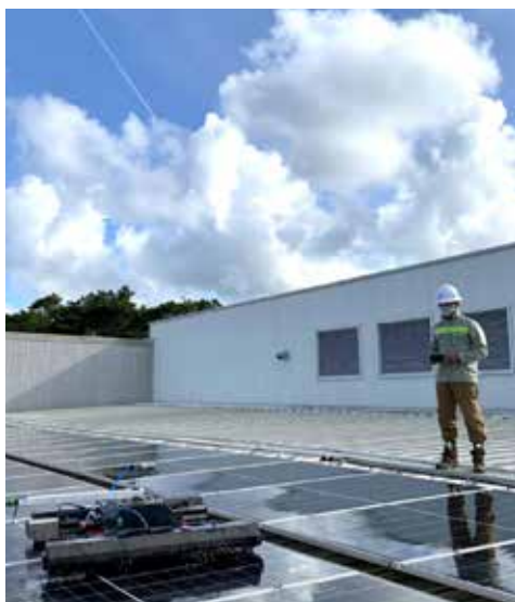
Hình 28: Sử dụng rô-bốt để vệ sinh tấm quang điện
