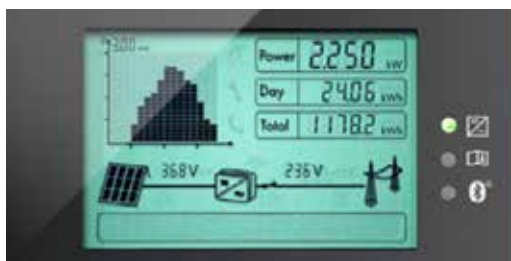
Hình 40: Đèn báo biến tần hoạt động bình thường (màu xanh) và không bình thường (màu đỏ)
