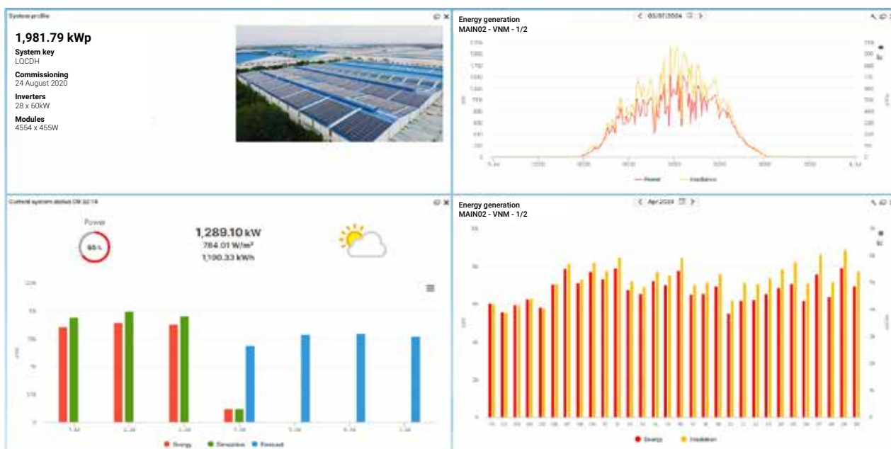
Hình 20: Công suất và sản lượng ĐMTMN được theo dõi qua hệ thống giám sát
