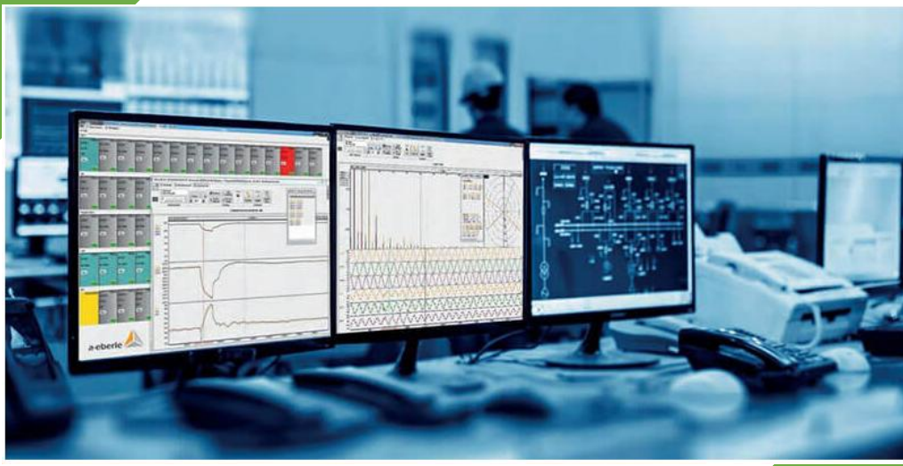
Hình 17. Hệ thống giám sát và đo lường, phân tích năng lượng
